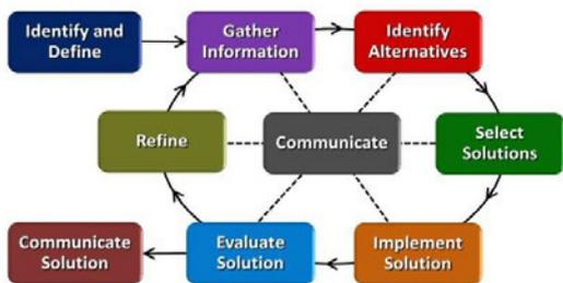
図1 EDP(Engineering Design Process)モデル
