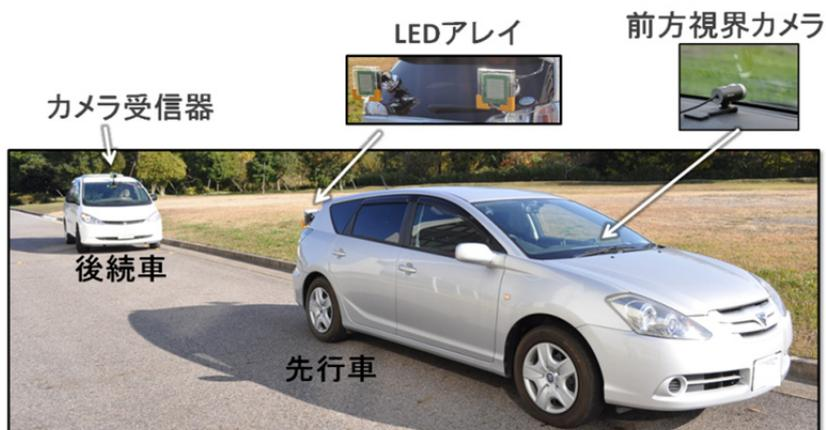
図 4.8 光車車間通信システムの外観
