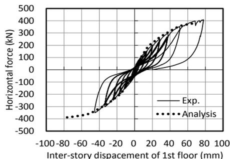
図 8 小幅パネル架構 1 層の荷重・変位
