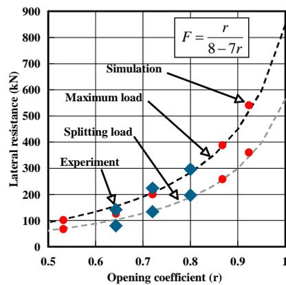
図 14 亀裂発生荷重、終局耐力と開口係数
