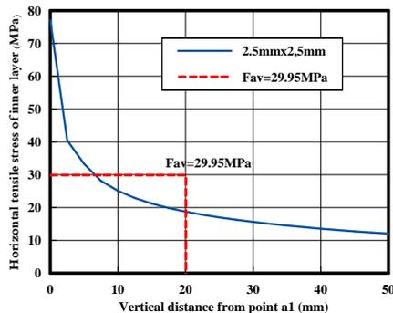
図 12 平均応力法による亀裂発生時の推定
