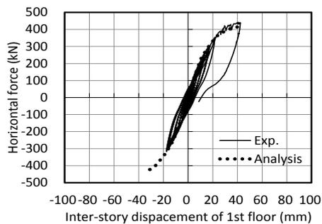
図 7 大版パネル架構 1 層の荷重・変位
