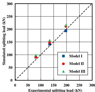
図 13 亀裂発生荷重の実験値と解析値
