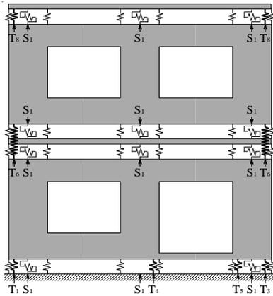
図 3 大版パネル架構の解析モデル
