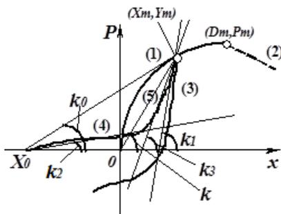
図 4 CLT パネル復元力特性のモデル化
