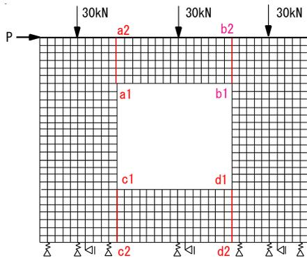
図 6 開口付 CLT 耐力壁の解析モデル
