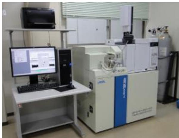
図1 ガスクロマトグラフ／質量分析計（日本電子製 JMS T100GCv）
