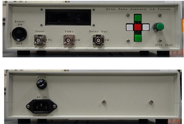
図 4：開発したディレイゲートパルサーのフロントパネル(上)とリアパネル(下)
