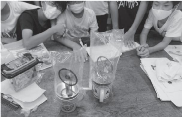
袋は全く動かない中、スターリングエンジンが動作している様子を観察した子どもからは、「排気ガスが出ないエンジンは未来のエンジンだ」という発言が聞かれた。また、子どもたちの「上をもっと冷やし、下をもっと熱したらどうなるのだろう」という疑問に対しては、「上をもっと冷やし、下をもっと熱したら、さらに速く動作するかもしれない」など、動作原理に基づいた動作の向上を求める意見や、実際に動作原理を確かめようという思いが出されたため、実際に試した。メインシリンダーの上部（お湯で熱せられる部分の反対側）に保冷剤を置くと、さらに空気が冷やされ、回転が速くなり、回転時間が延びた。
