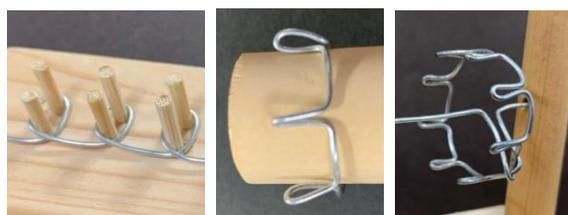
図 13 歯車機構の製作工程 (左：製作に使用した治具、中：丸棒への巻き付け、右：ピン歯車に整形)
