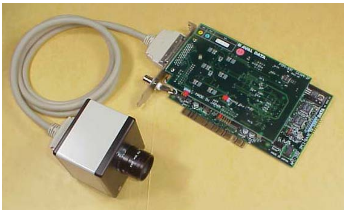
図 3-25 スマートカメラモジュール及び画像ボード
