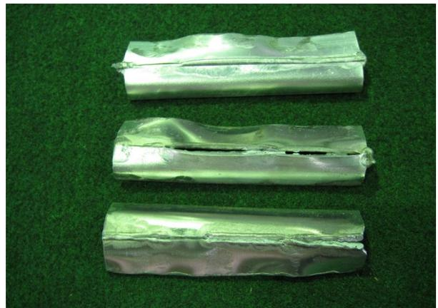
写真5 突き合わせ溶接曲げ試験
