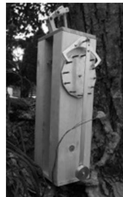
図26 機械式振り時計 (一部金属製)
