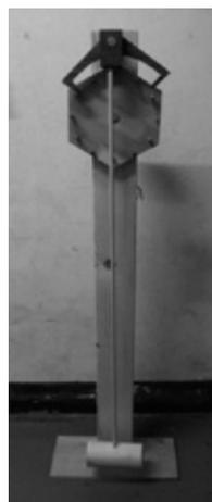
図25 機械式振り時計 (木製)
