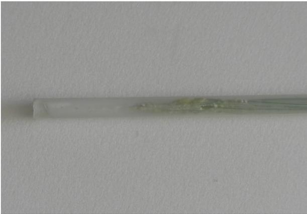
写真6. 完成した多点計測用熱電対
