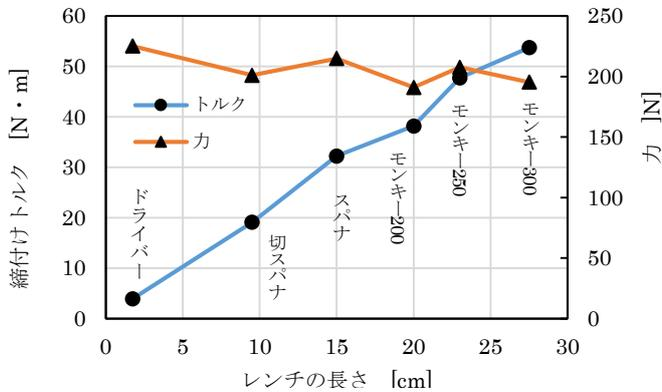
図6 工具と締め付けトルクの関係
