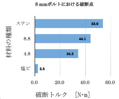
図5 ボルトの材質と破断点の関係
