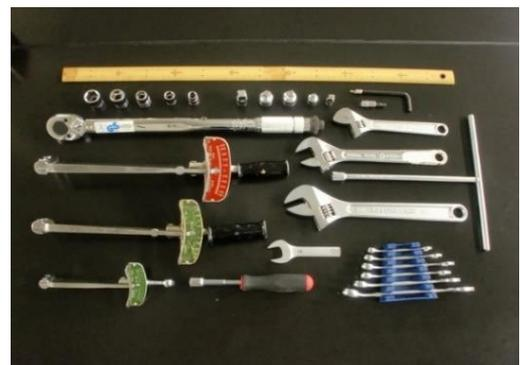
写真2 トルク測定工具
