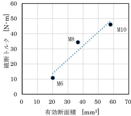
図4 有効断面積と破断点の関係
