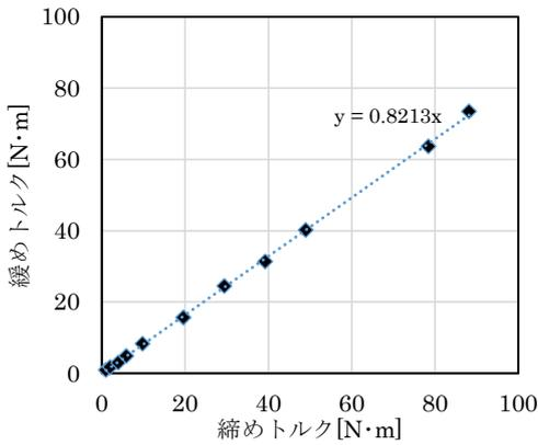
図3 ボルトの締めと緩みの繰り返し
