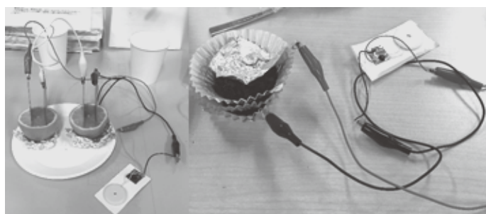
図1 レモン電池とアルミカップ電池
