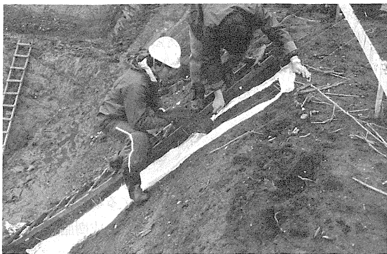
写真2. 固化した樹脂を順に剥ぎ取ってゆく。
