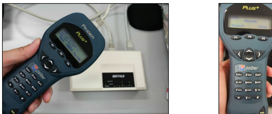
図1 Pinger Plus Network IP Tester において適切なリンク信号が見つかった際の表示（左） リンク信号が見つからない場合の表示、「NoLink」と表示されている（右）
