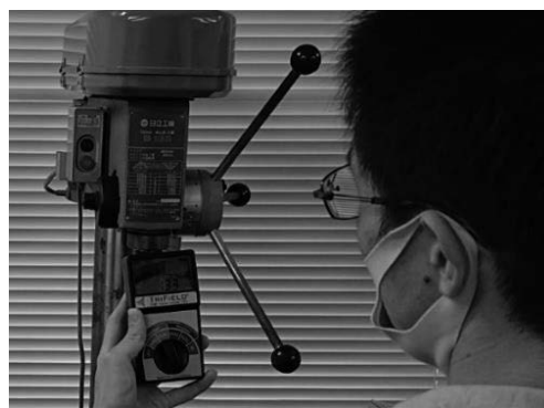
図5 ボール盤から発生する電磁波測定の様子
