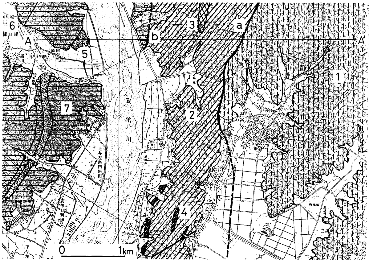
図1 静岡市域北郊外の地質図 a糸魚川・静岡線, b十枚山構造線, 1静岡層群, 2竜爪層群(粗面玄武岩), 3同上(松脂岩), 4同上(斑岩), 5瀬戸川層群(砂岩), 6同上(砂岩が頁岩互層), 7同上(頁岩が砂岩互層)
