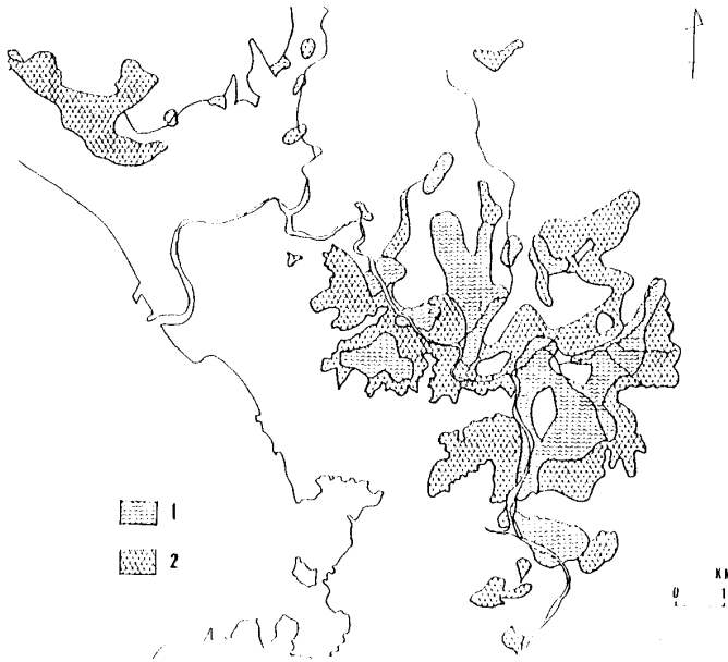
図3. 軟弱地盤分布図 1. 軟弱地盤AおよびB 2. 軟弱地盤CおよびD
