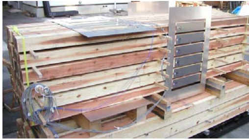
図3 実大材の積積みと電極対
