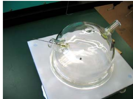
写真7 完成したドームの排気試験
