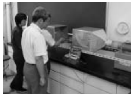
図4 換気装置風速測定
