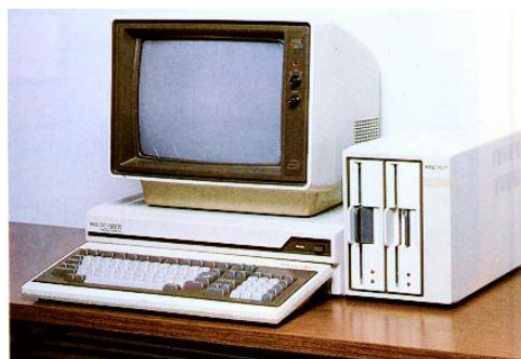
パーソナルコンピュータ NEC PC-9801 CPUは \mu PD8086 (Intel 8086互換)
