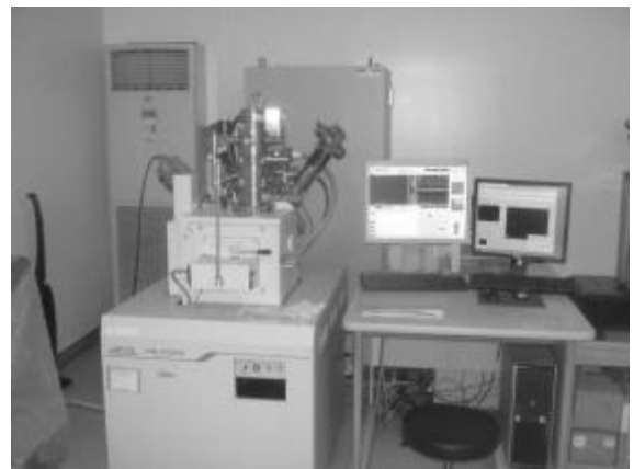
写真 1. 複合ビーム観察加工装置 JIB-4500
