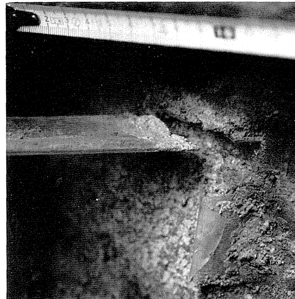
5. ガラス板が示すその 後の変動量 水平方向 14 mm 垂直方向 7 mm 昭和49年12月24日 撮影
