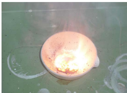
図 1 過マンガン酸カリウムとグリセリンの混触燃焼の様子
