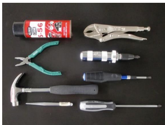
写真3 錆びたネジの外し方に使用した工具
