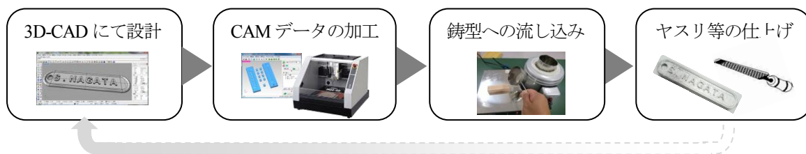
図1 鋳造モデル製作の流れ
