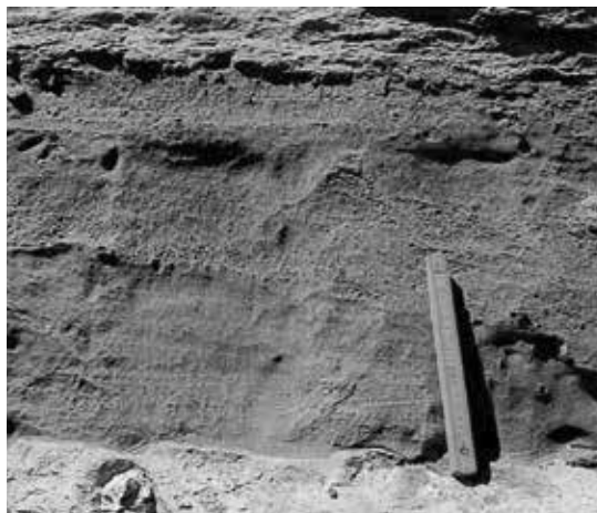
図4. 露頭下部の砂層. 下位より層厚 5cm, 平行葉理を呈する極細粒砂層. 層厚 8cm, 斜交葉理を呈する極細粒砂層. 層厚 4cm, 平行葉理を呈する粗粒砂層. 層厚 10cm, 平行葉理を呈する極細粒砂層. 層厚 8cm, 平行葉理を呈する粗粒砂層. スケールは 20cm.
