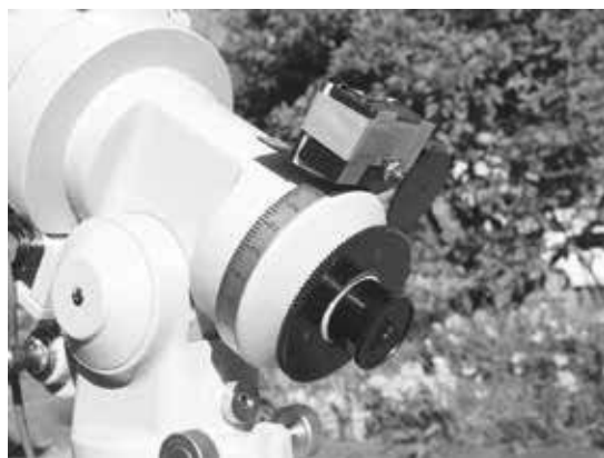
図2. 取り付け部を自作したエンコーダ。
