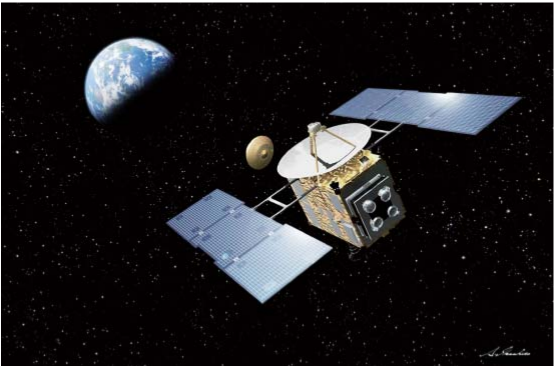
写真. 「はやぶさ」とカプセル, そして, 地球. 「はやぶさ」の重さは510 kg, 太陽電池パドル (3枚合わせて) の長さは5.7 m. (画; 池下章裕)
