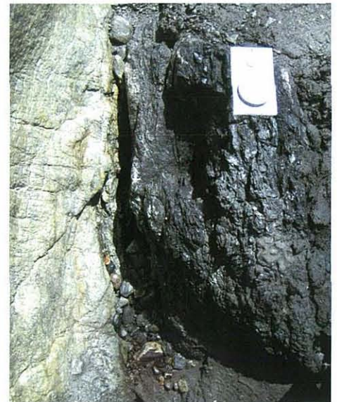
3. 断層にそう破碎帯（写真1 最深部の露頭を上方から撮影）。左側の明色部はひん岩、右側の暗色部は砂岩優勢砂岩泥岩互層起源のカタクレーサイト。
