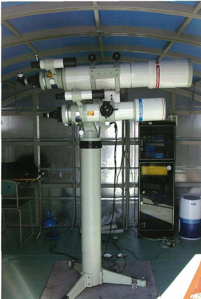
5. 上：高橋 TOA130，口径 13 cm 屈折望遠鏡。 下：高橋 FCT100，口径 10 cm 屈折望遠鏡。 赤道儀は高橋 NJP。
