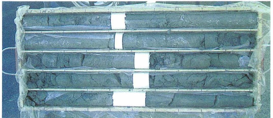
写真3. 採取されたボーリングコアは、1 m 毎に裁断され 5 m ごとに 1 つのコア箱に納めた。採集コアに含まれる微生物の分析のため、現場で 1 メートル毎に 10 センチの試料採取をし、取り出したコアの部分には発泡スチロール製の白いスペーサーを入れた。
