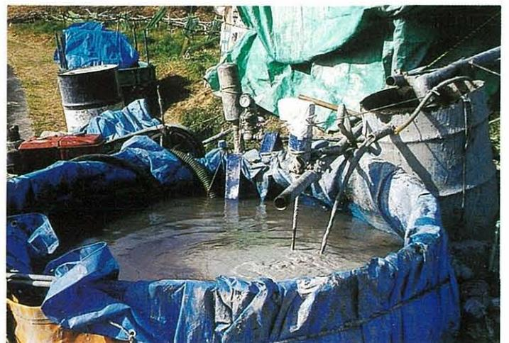
写真6. ボーリングの先端ビットを冷やすための循環水に浮く石油。循環水のプール槽に粘土と石油が混じった黒い層が溜まり、琥珀色の石油が浮いてくる。
