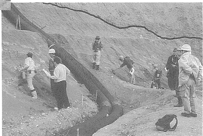
写真2 空港ターミナル予定地点の露頭観察 黒線は相良層群切山泥岩優勢互層(下部) と坂部原礫層(上部)との境界(不整合)
