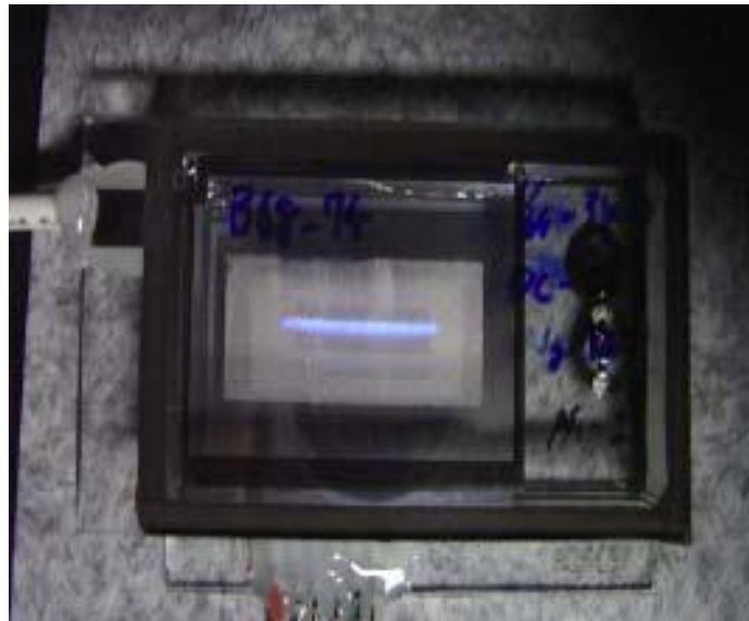
図 1.8 フィールドエミッションアレイを励起源に使用した 電子線励起型深紫外発光デバイスの外観図 40)
