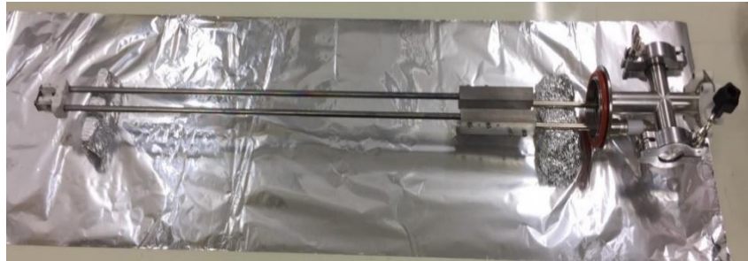
図 5.19 W 抵抗加熱機構全体図
