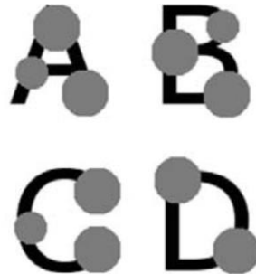
図 2-4 アモーダル補完を利用した文字列 CAPTCHA のコンセプト図 (文献[17]より引用)
