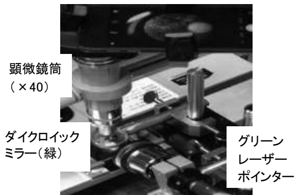
図 17 学生実験用簡易型蛍光顕微鏡
