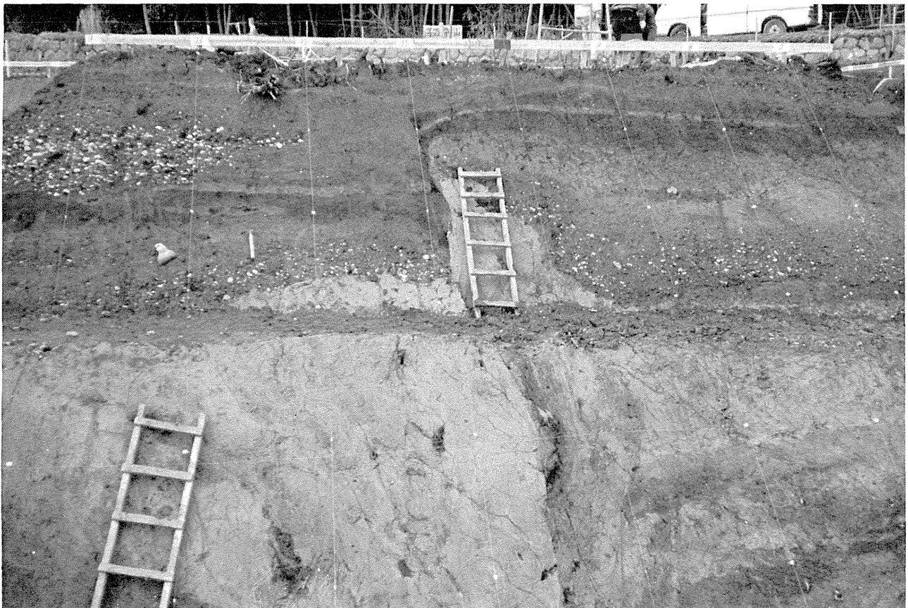
写真2. トレンチ内の中央丘の南壁に現われた丹那断層。法面に張られた糸の間隔は1 mである。
