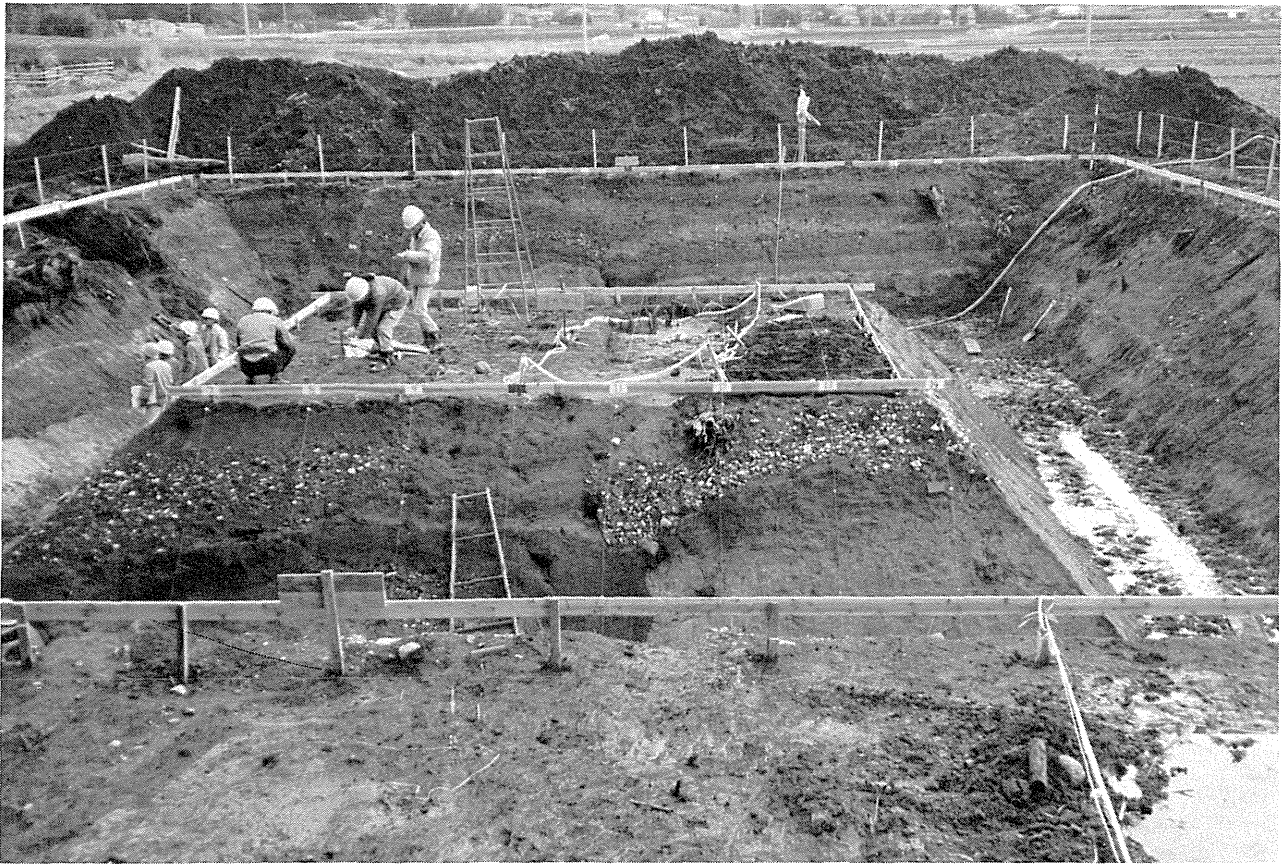
写真1. 丹那断層発掘現場を北側から望む。写真中央部に断層に沿って黒土層が落ちこんでいるのが見える。
