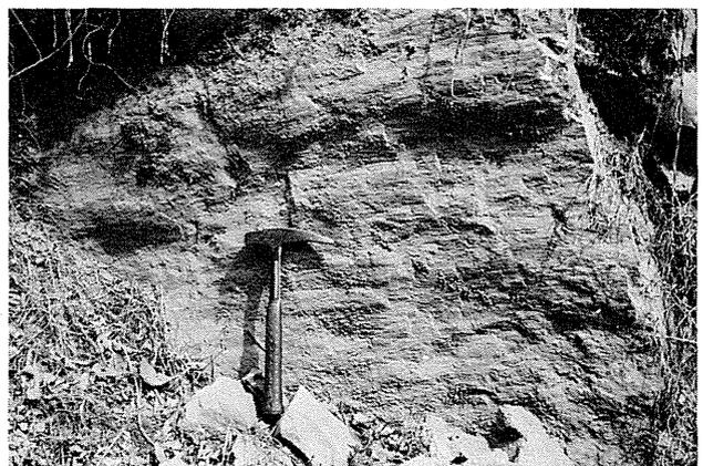
5.6. 断層面に発達する条線。5と6で条線の太さ，間隔などがうことに注意。両者ともに横すべり断層であるが，5ではその向きは分らない。6では条線の非対称な形態から左横すべりであることが分る。
