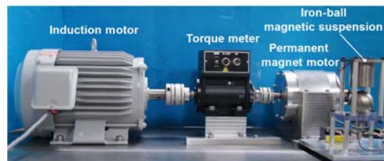
図7 IPM モータと鉄球磁気浮上装置
