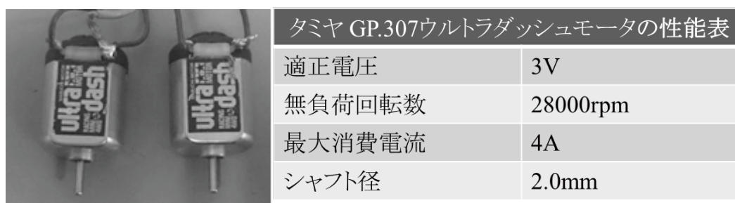
図4 使用したモータ及び性能表
