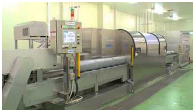
水圧を利用した超高压処理装置
