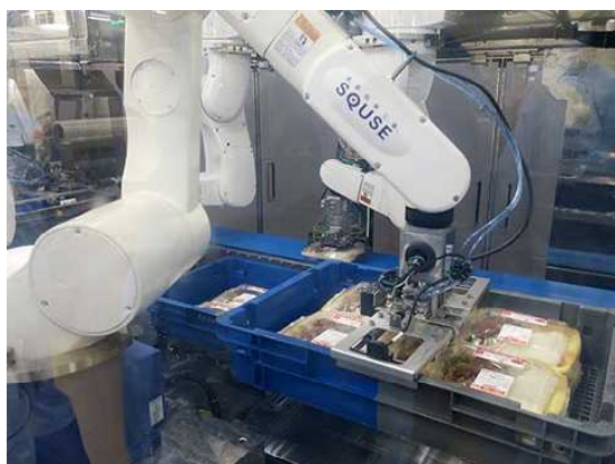
空気圧を利用してものを運ぶロボット
