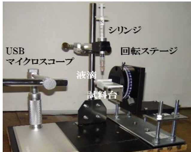
図3 USB マイクロスコープを利用した接触角計
