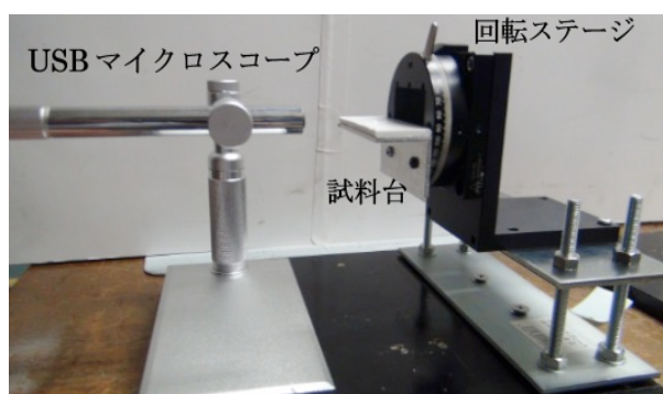
図1 試作した動的接触角計
