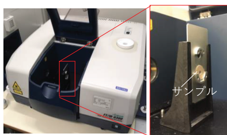
図 6 KBr 錠剤法による透過法
