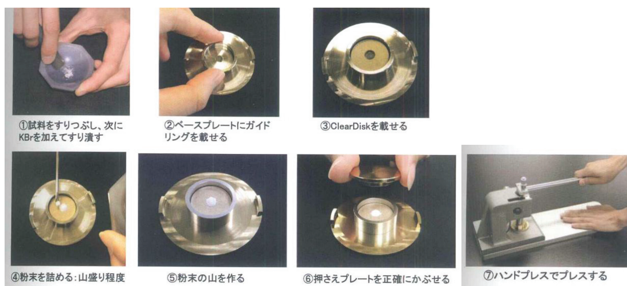
図 5 KBr 錠剤法のサンプル調製法
