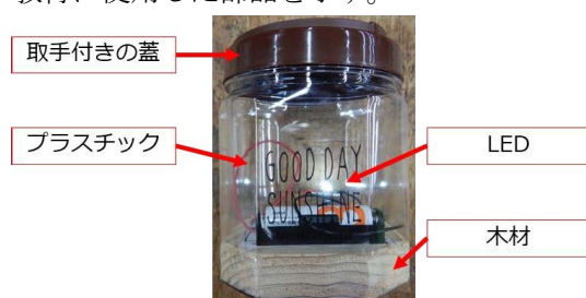
図 1 開発した LED ランタン教材
