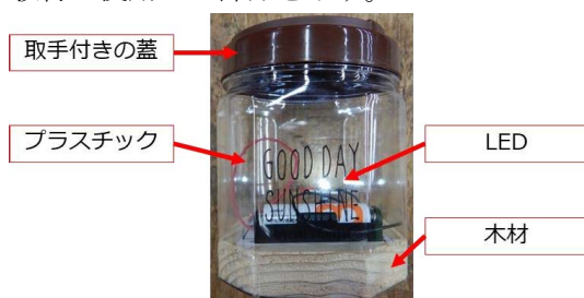
図 1 開発した LED ランタン教材
