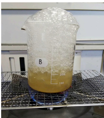
図6 うるち米飴の加熱濃縮工程
