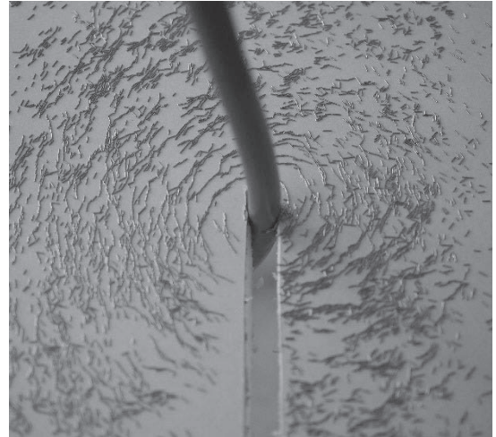
図 25 鉄粉を用いて導線の周りの磁界を調べるようす
