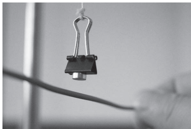
図 22 導線1本で磁石振り子を揺らすようす
