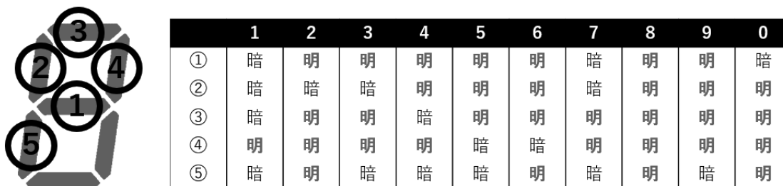
図 4. 照度センサで数値を読み取る仕組み
