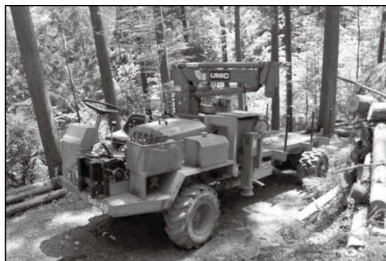
図7 クレーン付き林内運搬車
